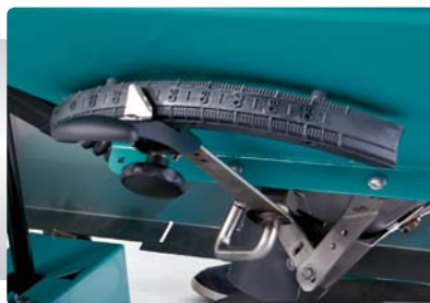
Нови, лесни за разчитане и подробни градуирани сектори за нормата на тороразпръскване
