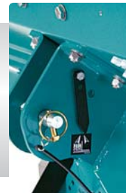
Индикатор за наклона при торене в късна фаза на посевете
