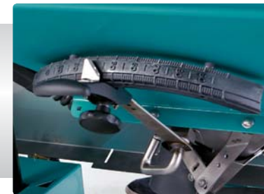
Нови, лесни за разчитане и подробни градуирани сектори за нормата на тороразпръскване
